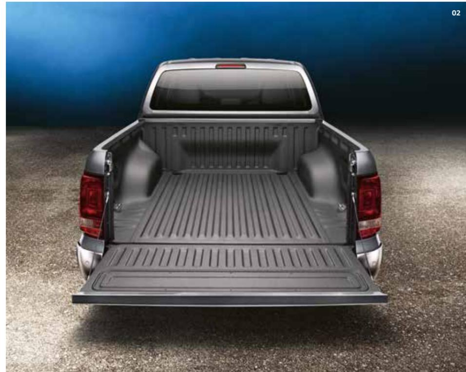
**02 Laderaumbeschichtung.** Hohen Schutz vor mechanischen und chemischen Gebrauchsspuren bietet die UV-beständige Spezialbeschichtung in Anthrazit. | CL | HL | AV |
