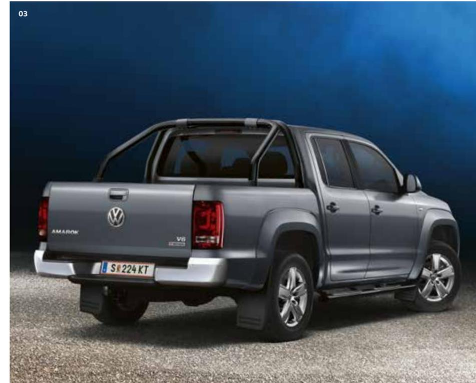
**03 Stylepaket in Schwarz, matt.**<sup>1)</sup> Dieses Paket macht den Amarok noch eine Spur maskuliner. Die Stylingbar<sup>2)</sup> aus Stahl hat einen Rohrdurchmesser von 76 mm und ist schwarz pulverbeschichtet. Schwarze Schwellerrohre, auf Wunsch mit LED-Beleuchtung, mit rutschfesten Trittflächen und eine in die dritte Bremsleuchte integrierte Ladeflächenbeleuchtung runden den markanten Auftritt ab. | CL | HL |
