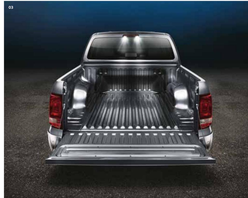
**03 Ladeflächenbeleuchtung.** Sie leuchtet die Ladefläche weiträumig aus und ermöglicht dadurch ein Beladen bei Dunkelheit. Zusätzlich ist in ihr die dritte Bremsleuchte integriert. | CL | HL | AV |
