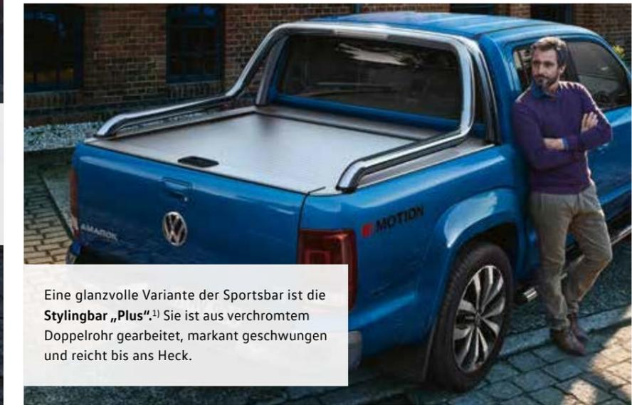
Eine glanzvolle Variante der Sportsbar ist die **Stylingbar „Plus“**.<sup>1)</sup> Sie ist aus verchromtem Doppelrohr gearbeitet, markant geschwungen und reicht bis ans Heck.
