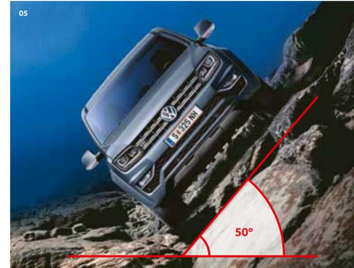
**04 Böschungswinkel und Wattiefe.** Die maximalen Böschungswinkel des Amarok betragen 29,5° vorn und 18,0° hinten. Wasserdurchfahrten sind bis zu einer Wattiefe von 500 mm möglich. | CL | HL | AV |
