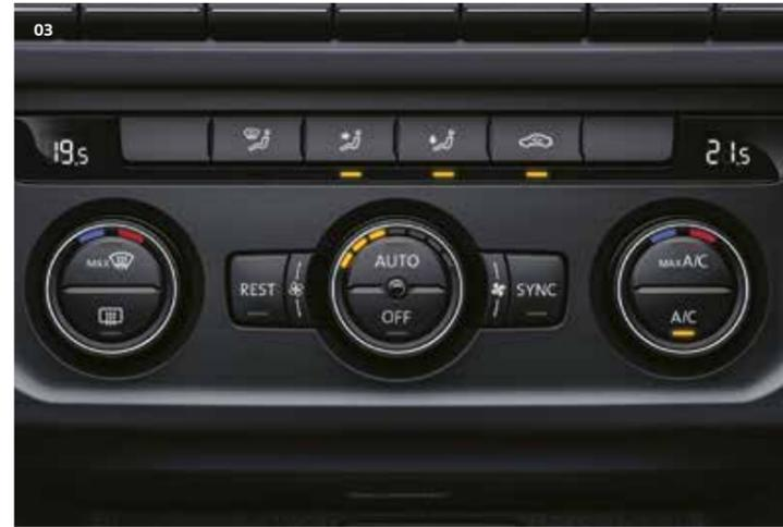
**03 Klimaanlage „Climatronic“ inklusive Allergenfilter.** Dieses System bietet eine 2-Zonen-Temperaturregelung für Fahrer und Beifahrer sowie eine manuelle Umluftfunktion. Abhängig von der Sonneneinstrahlung und der Außentemperatur führt die Klimaanlage mehr oder weniger kühle Luft zu. Die Beschichtung des Allergenfilters hält auch feinste Partikel wie allergieauslösende Stoffe zurück. | CL | HL | AV |
