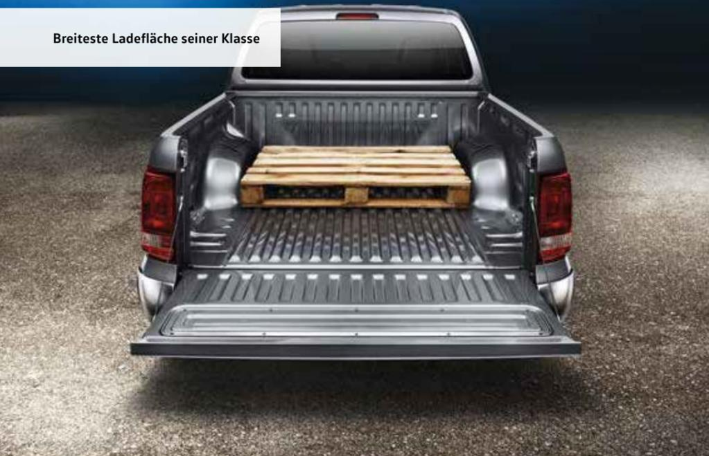
**01 Ladefläche.** Genau 1.222 mm misst die Ladefläche des Amarok zwischen den Radkästen – das ist einmalig in dieser Fahrzeugklasse und ermöglicht das Querladen von Europaletten. Bei Bedarf kann die mit bis zu 200 kg belastbare Ladeklappe als Verlängerung des Laderaums genutzt werden. Zudem bietet die Cargobox bei randhoher Befüllung Raum für 1,28 m<sup>3</sup> Schüttgut auf einer Grundfläche von 2,52 m<sup>2</sup>. | CL | HL | AV |
