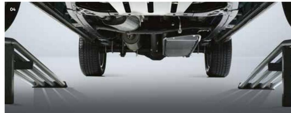
**04 Unterfahrschutz aus Stahl.** Robuste Stahlbleche schützen den Tank bestmöglich vor Steinschlag und auf dem Boden liegendem Geäst. | CL | HL | AV |
