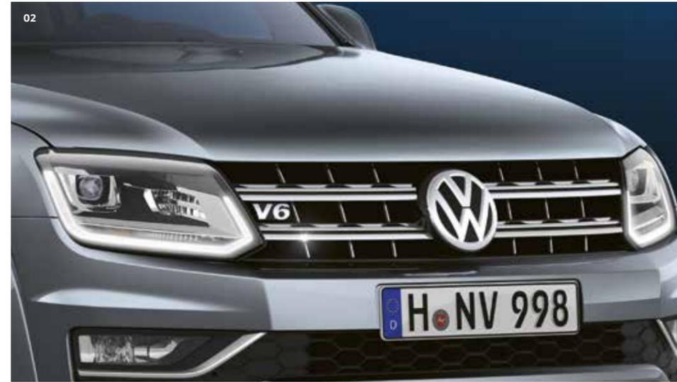
**02 Bi-Xenon-Scheinwerfer mit LED-Tagfahrlicht.** Sowohl das Abblend- als auch das Fernlicht werden über die Bi-Xenon-Scheinwerfer erzeugt. Dies erweitert das Sichtfeld und erhöht die Sicherheit. Das elegante LED-Lichtband übernimmt das Tagfahrlicht. | CL | HL | AV |
